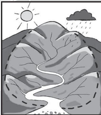
Uma Bacia, quando representada em um plano, apresenta a forma geral de uma pêra e, em qualquer situação, a sua superfície é côncava o que determina a direção geral do escoamento da água.
